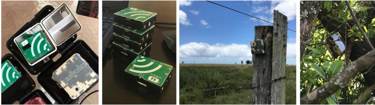
**Figura 7.** Grabadores autónomos AudioMoth utilizados para el muestreo acústico pasivo.
